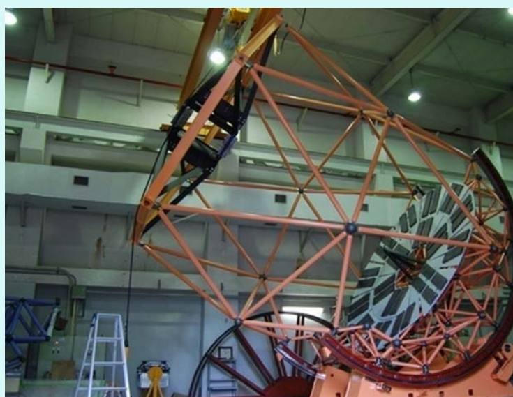
高度軸駆動試験中の3.8m望遠鏡写真
